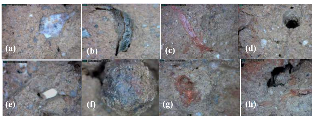
Figura 83: (a) Quartzo; (b) e (c) Raiz; (d) Cavidade; (e) Mica; (f) Micaxisto; (g) Chamote; (h) Cavidade e raiz;
