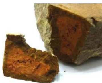
Figura 72: Feição e cor da pasta cerâmica da amostra T4
