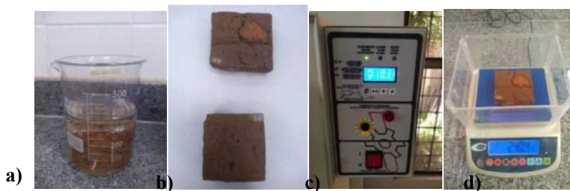
Figura 61: (a) Submersão da amostra na água destilada; (b) Aparências das amostras; (c) Submissão a estufa; (d) Pesagem
